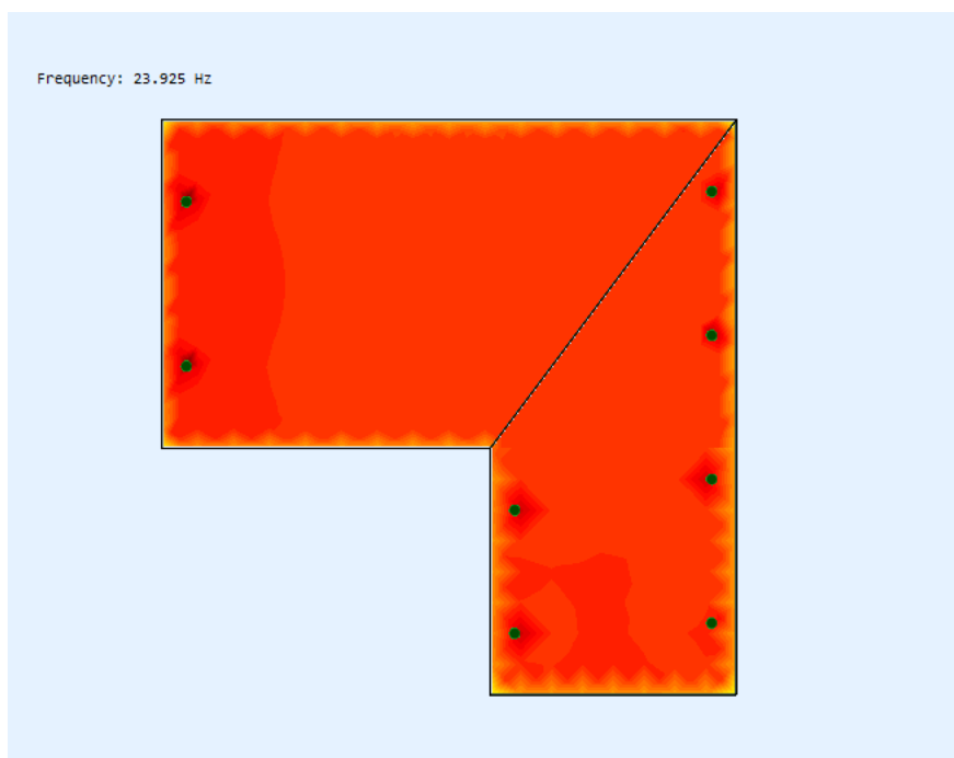
Abbildung 5: 1. Längsmode (ca. 24 Hz) im gesamten Raum
